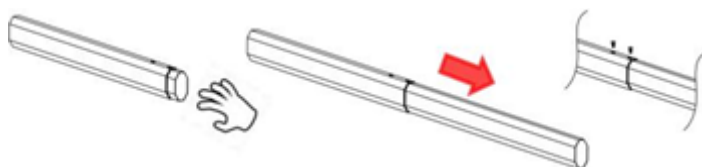
Рис.1 Соедините главную стрелу со вспомогательной стрелой 2 винтами
