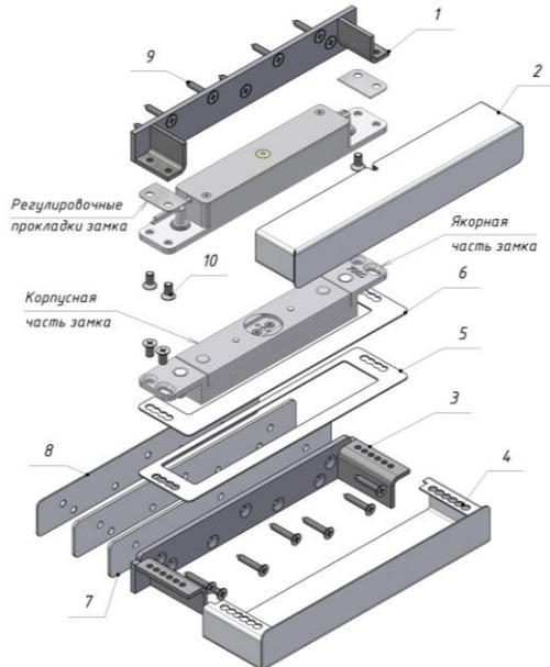
Рисунок 1 – Установка замка ALM-700S с комплектом МК 700S-PS
