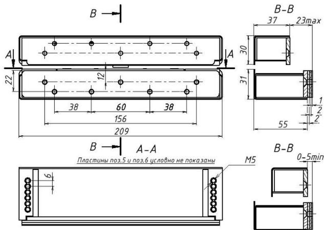
Рисунок 2 – Габаритно-установочные размеры комплекта МК 700S-PS
